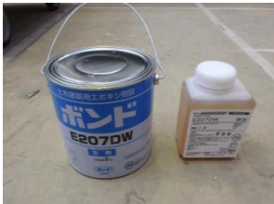
図 4.2.2-11 充填用エポキシ樹脂 (コニシ製 E207D)
