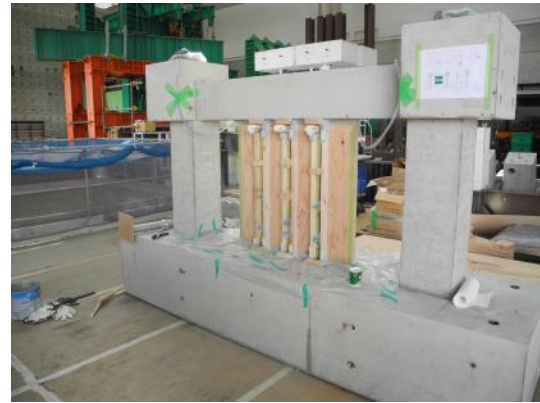
図 4.2.2-10 接着剤充填完了状況
