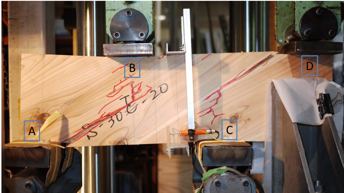
図 5.1.3-6 荷点 B-C 間に引張力が生じる CLT(30°)
