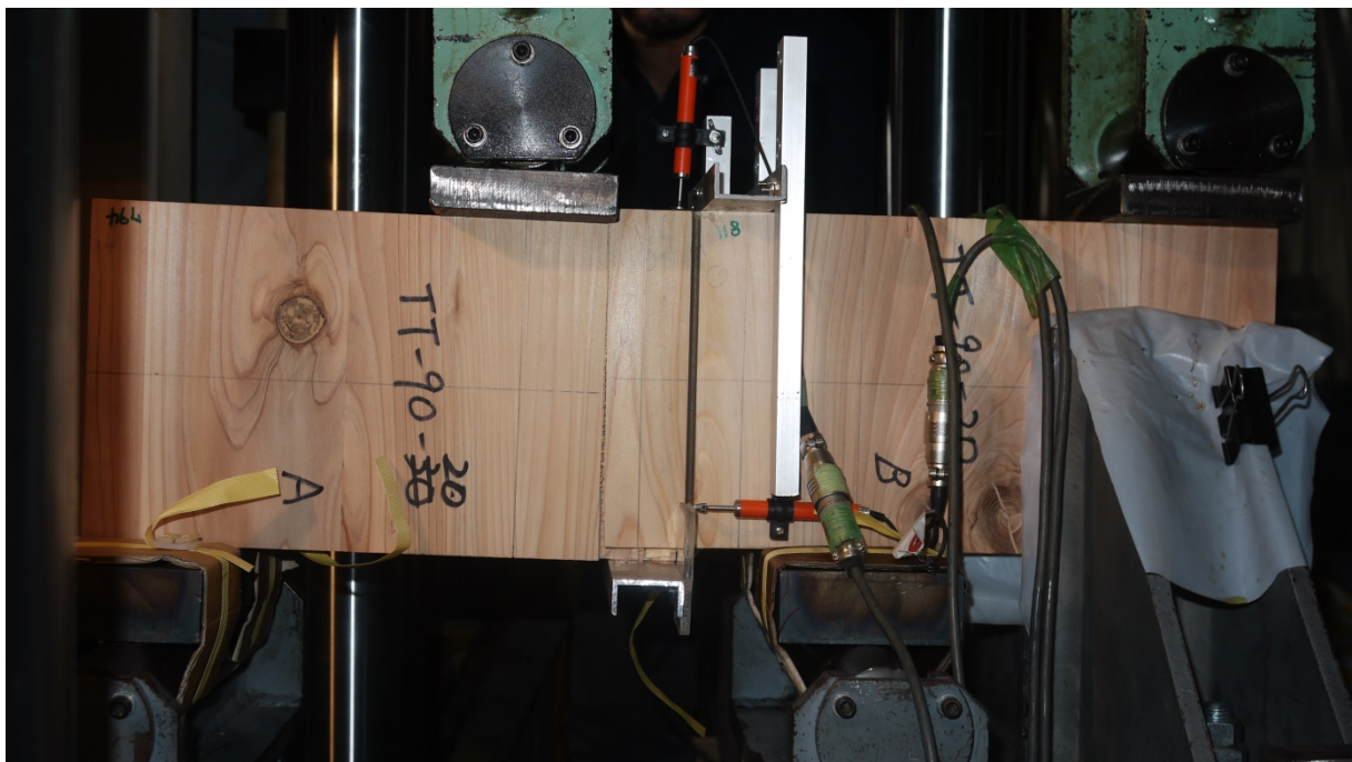
図 5.1.4-3 表層のラミナが加力方向に対して、直行した繊維方向をもつ CLT(0°)
