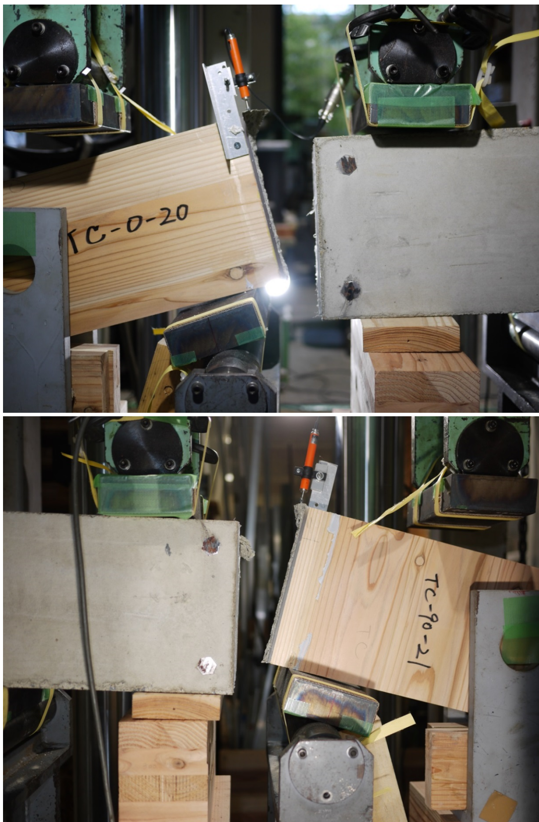
図 5.1.5-5 各試験体の破壊状況(上から 0°, 90°)
