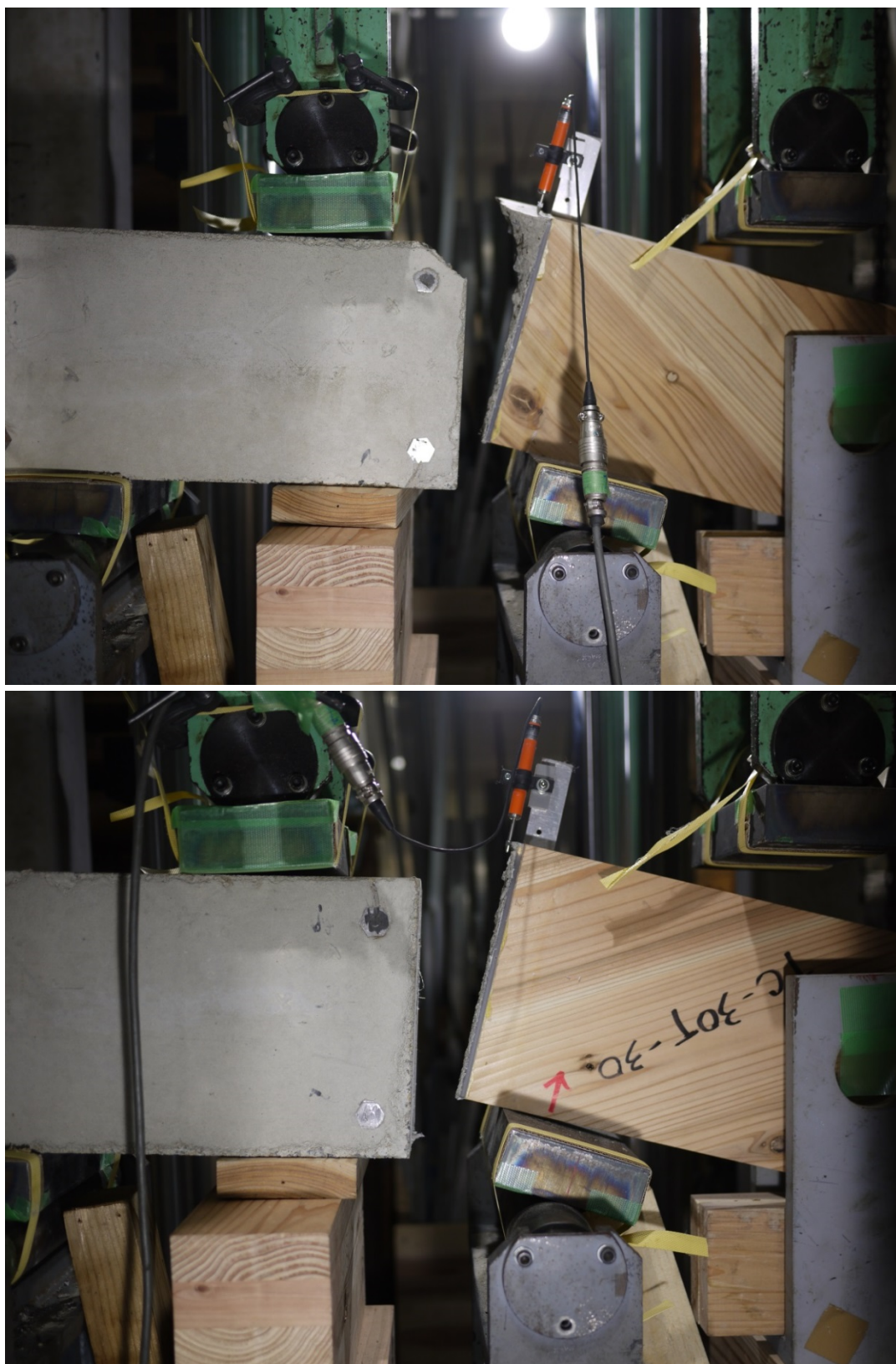
図 5.1.5-6 各試験体の破壊状況(上から -30^{\circ} , 30^{\circ} )
