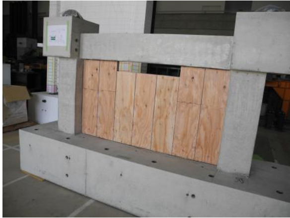
図 4.2.2-14 施工完了状況 (設備開口試験体)
