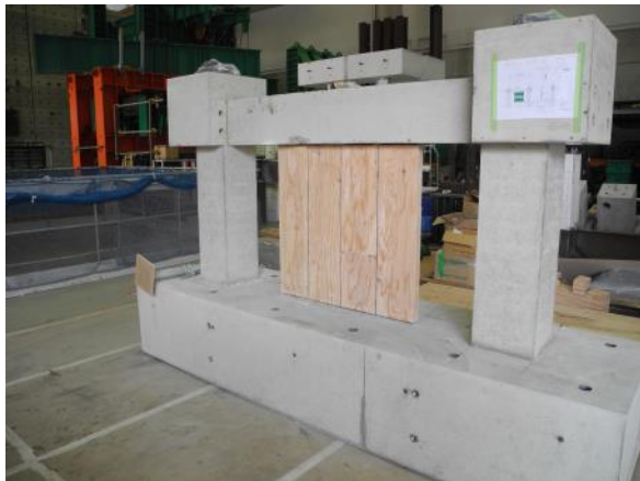
図 4.2.2-16 施工完了状況 (方立壁試験体)
