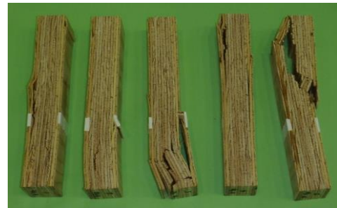
図 5.2.3-4 試験体破壊状況 (繊維直交方向加力)
