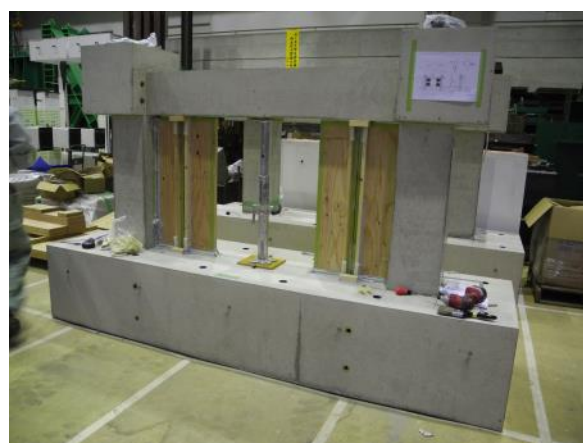
図 4.2.2-8 型枠施工完了状況
