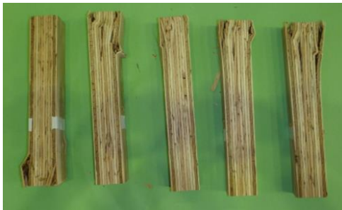
図 5.2.3-3 試験体破壊状況 (繊維方向加力)
